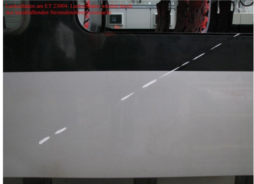
Lackschaden am ET 23004. Lackschaden wurden durch
