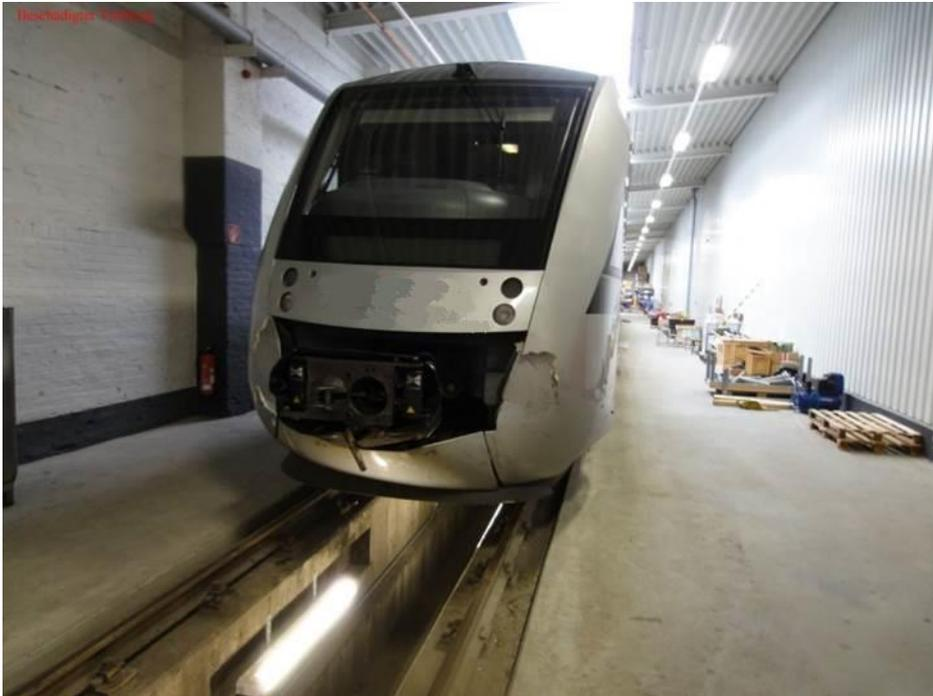
Die aerodynamische Front hat den Nachteil der fehlenden Stoßfänger, die die Aufprallenergie absorbieren!
