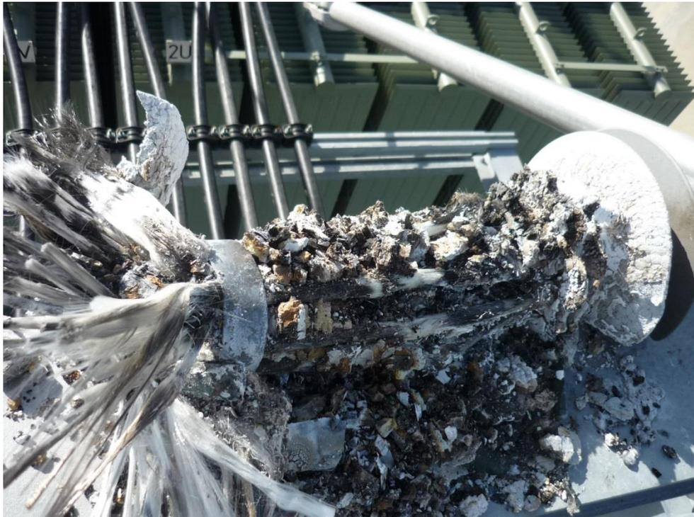
Ableiter auf der Hochspannungsseite pulverisiert!
