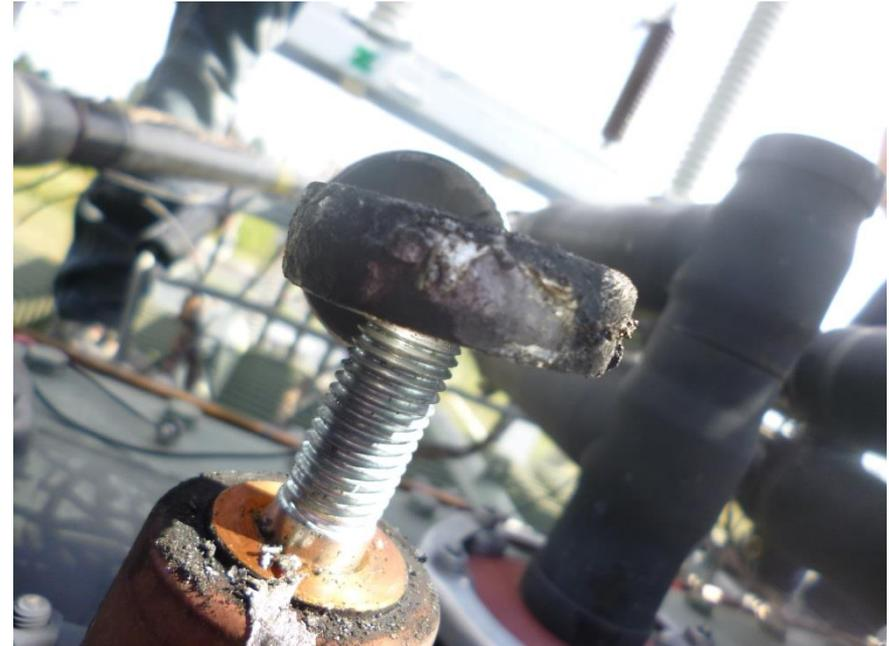
Abschmelzungen und verdrehter Einbau!
