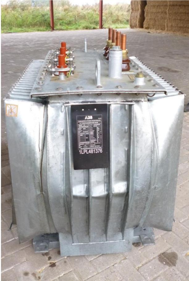
Kurzschluss im Blocktrafo 630kVA!
