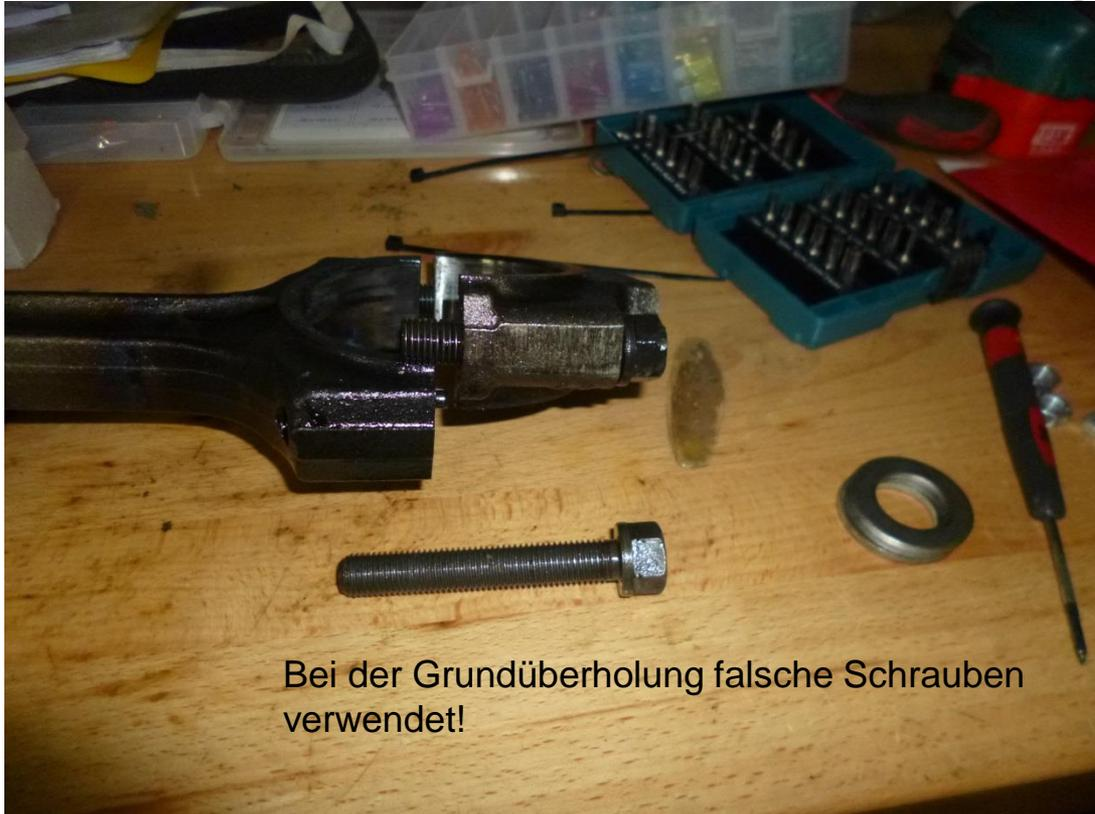
Bei der Grundüberholung falsche Schrauben verwendet!
