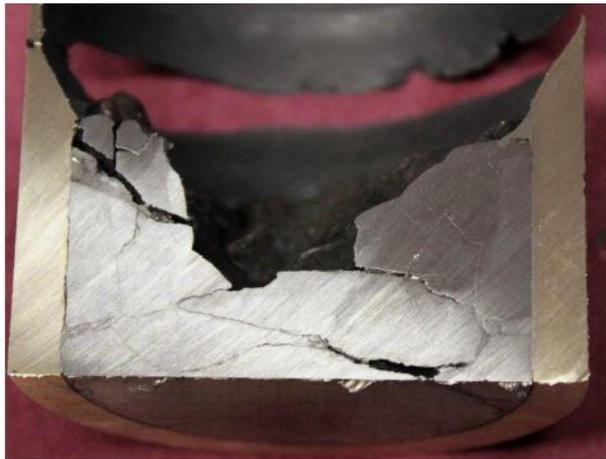
Bild 5: Längsschnitt durch den Wellenzapfen mit Bruch; interkristalline Trennungen
