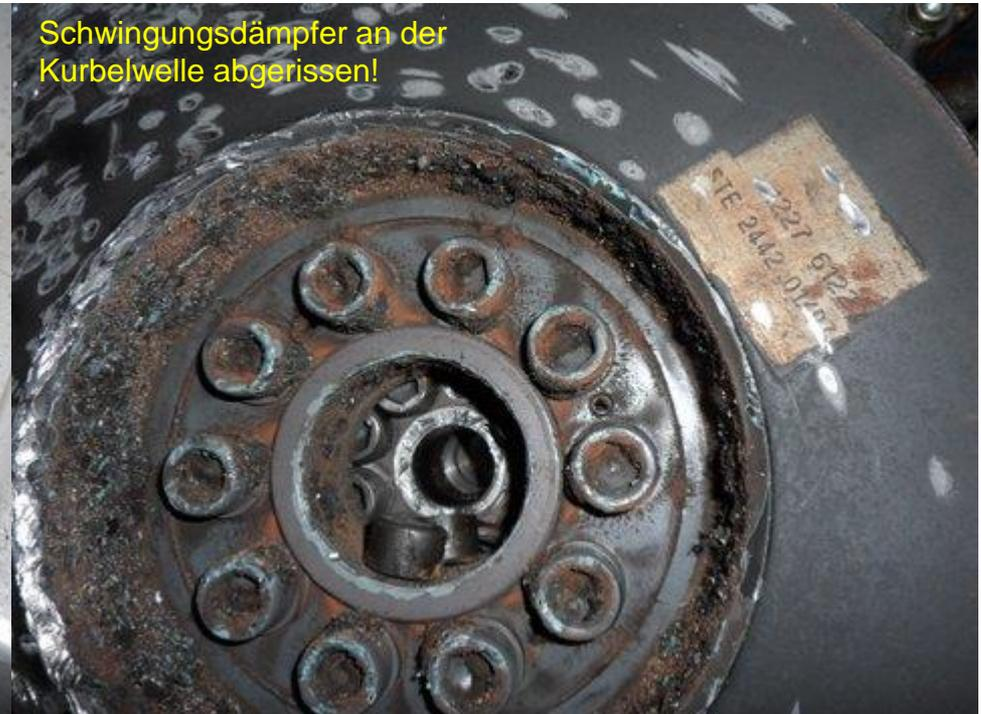
Schwingungsdämpfer an der Kurbelwelle abgerissen!
